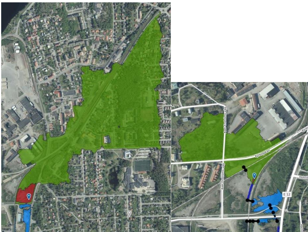
Figur 15. Påtryckande avrinningsområden som förbilds genom planområdet. Framtaget med Scalgo Live. Svarta punkter anger ungefärlig placering av trummor.
