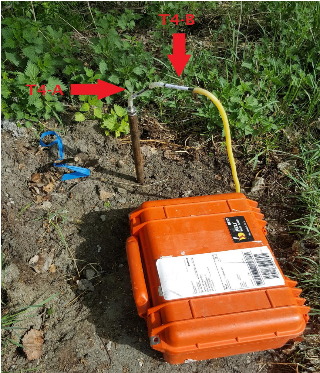
Bild 8: Provtagning av porluft i punkt T04.
