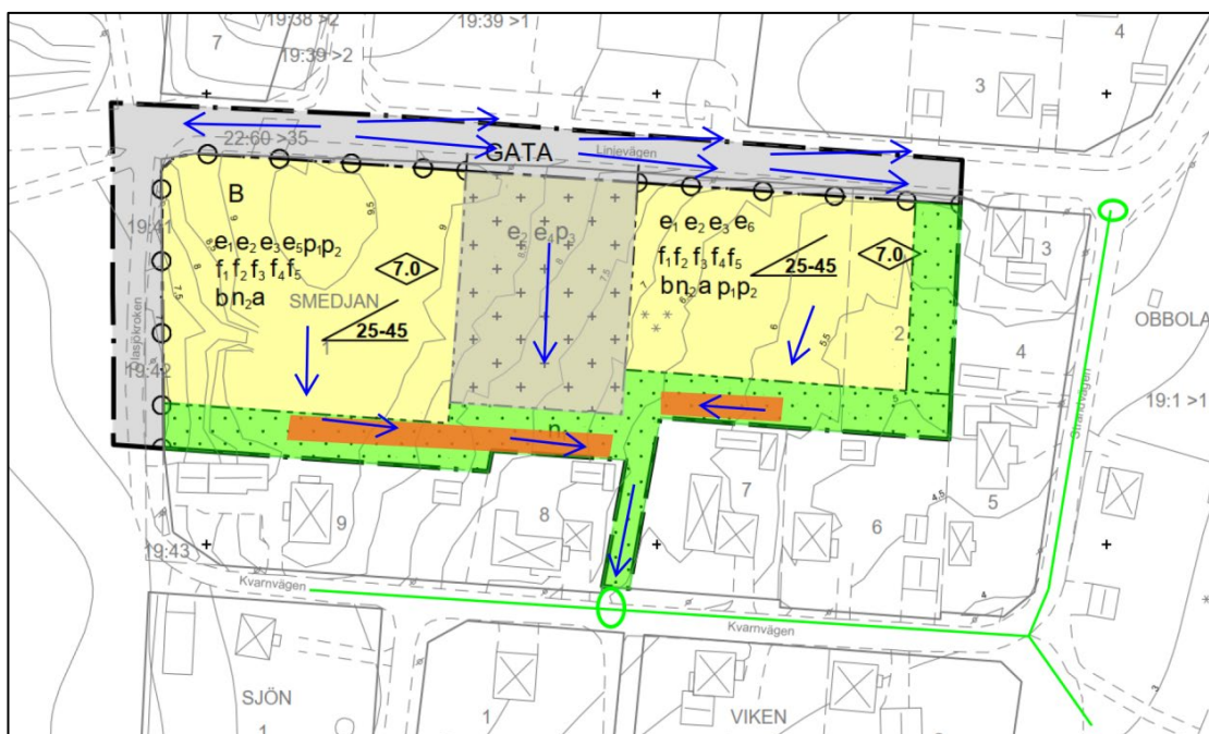
Figur 35: Översikt över föreslagen dagvattenlösning inom planområdet. Orange symboliserar dagvattendiken. Röd cirkel symboliserar möjlig placering av kuppelbrunn i dike och vidare avledning till det kommunala ledningsnätet (WSP, 2023).
