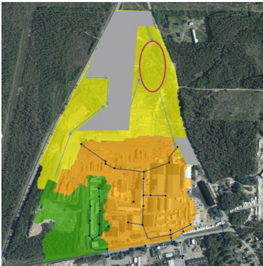
Figur 7.3.1. Översiktligt förslag på avledning av dagvattnet till det befintliga dagvattensystemet samt potentiella ytor för fördröjning och rening. Hårdgjorda ytor har markerats med grå, olika avrinningsområden till norra delen har färgen gul. Röd ring är möjlig placering av fördröjningsdamm.
