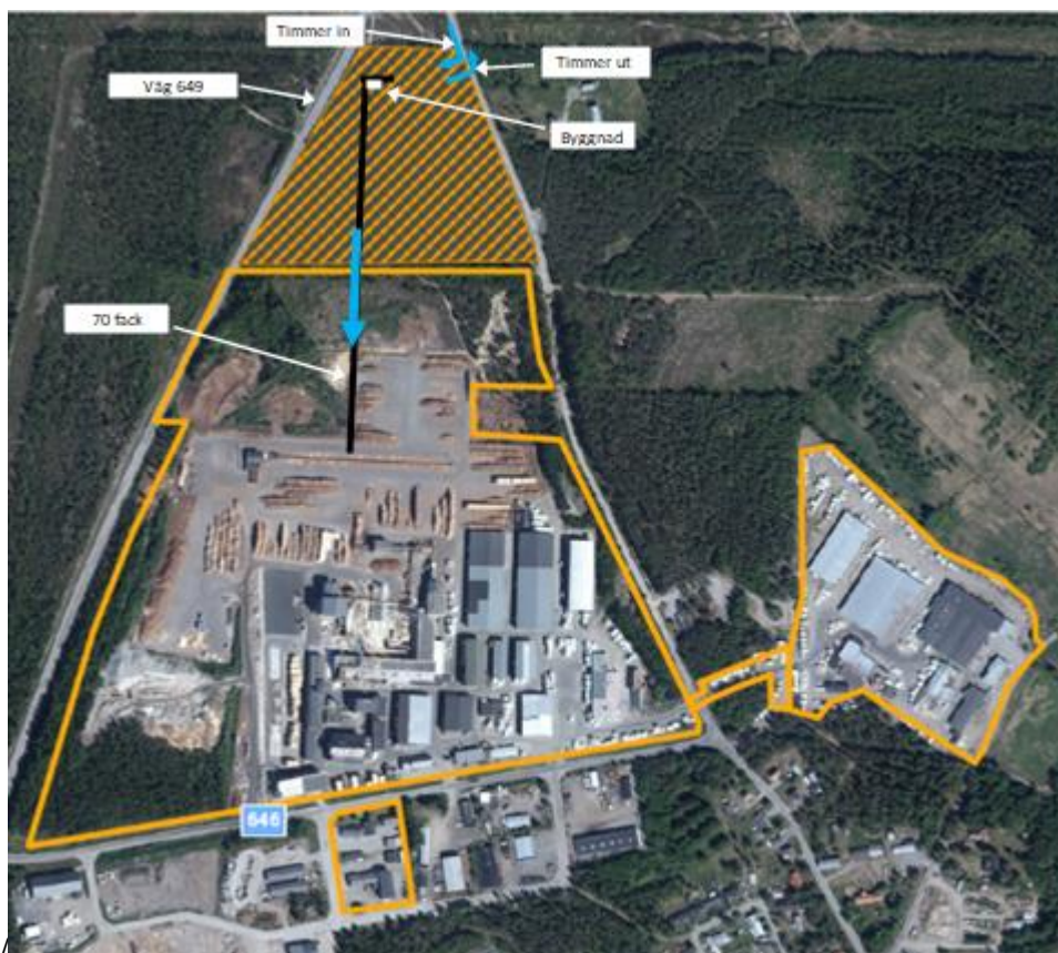
Figur 2.3. Möjlig placering av ny timmersortering på norra delen av fastigheten. Kartan är en preliminär principiell skiss. Den vita rektangeln är byggnad för personal, svart sträck illustrerar tänkt timmersortering och dess bana.
