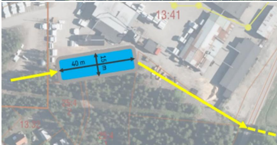
Figur 21. Schematisk principskiss för förslag av omledning av dagvattnet från det befintliga industriområdet över Pålböletomten 8:1 och Sävar 13:41. Källa: Sweco
