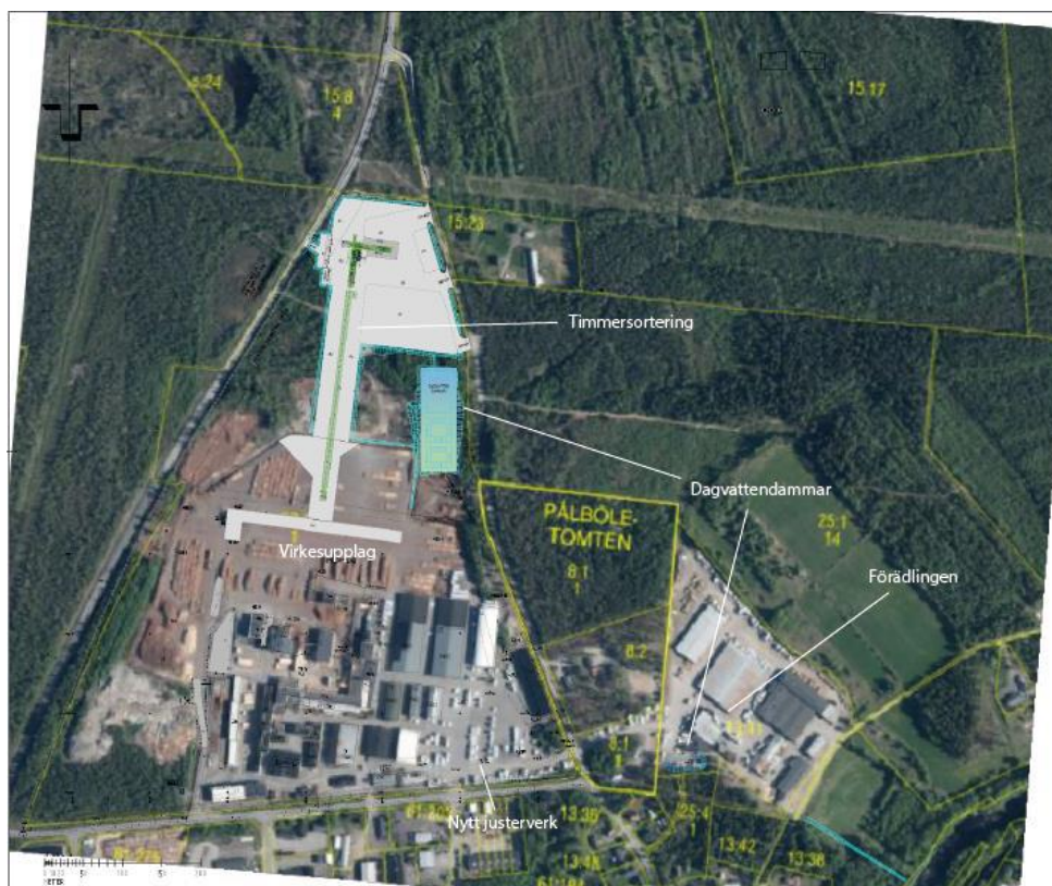
Figur 8. Illustration över sågverksamheten och dess anläggningsdelar efter planerad utbyggnad. Källa: Tyréns, bearbetning Umeå kommun
