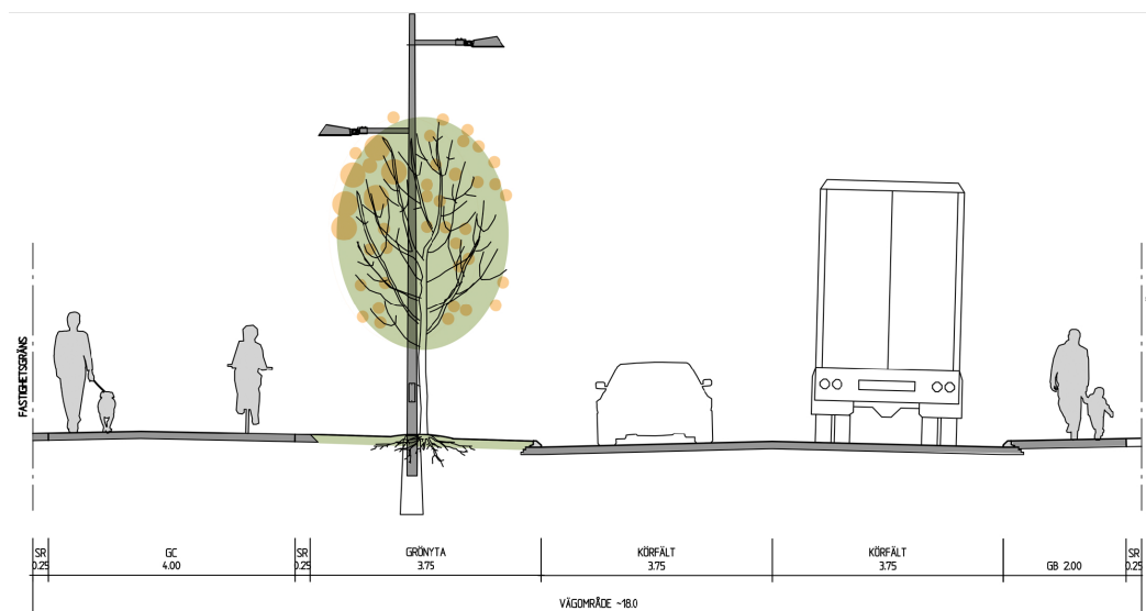
Figur 15. Exempel på tvärsnitt som visar hur den ombyggda Bölevägen skulle kunna se ut. Gång- och cykelvägen flyttas till norra sidan. Gångbana på södra sidan.
